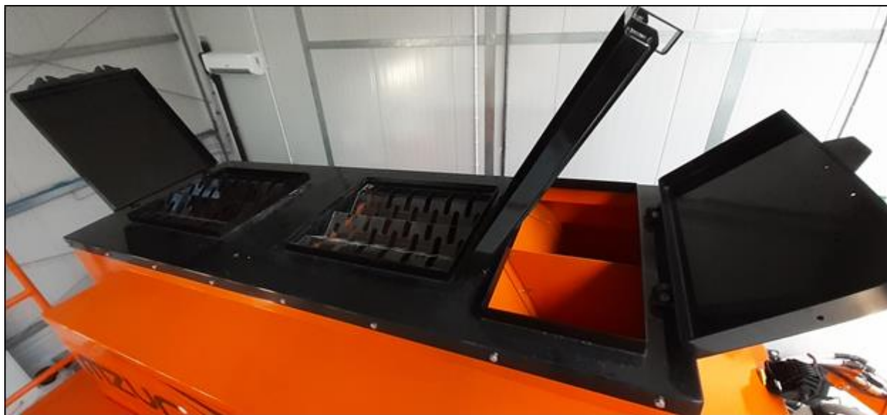
Fot. 3. Zbiorniki 4. komorowy w siewniku Mzuri Pro-Til 4Tx2
