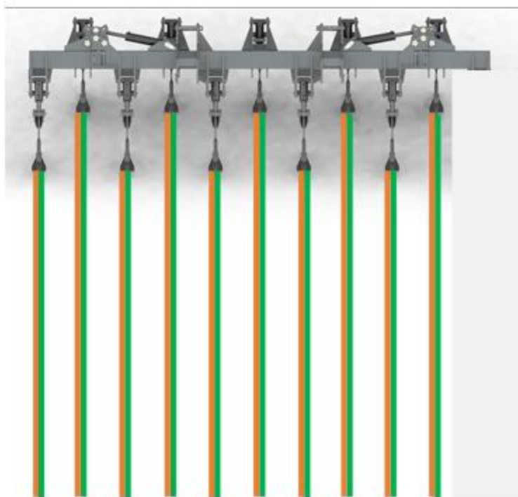
Fot. 9. Parzysta liczba sekcji do siewu mieszank na przemian rzędowych
